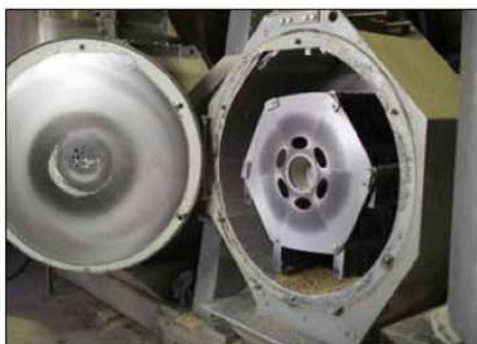
De nye møller er konstrueret med kraftige materialer, og kapaciteten er høj. Model SM-180 formaler op til 13 ton i timen.
